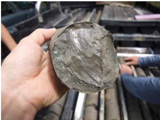
Ryc. 3. Zlustrowania z rysami ślizgowymi w ilach mioceniowych widoczne na przełamie rdzenia wiertniczego – osuwisko przy ul. Starzyńskiego. Fot. M. Wódka, 2017 r.
